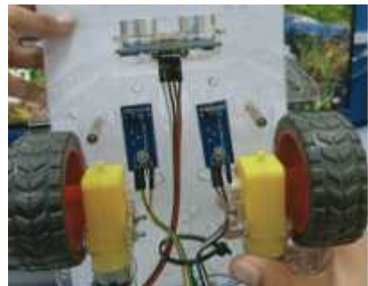
Gambar 4. 7 Hasil rangkaian arduino dengan sensor line followers
