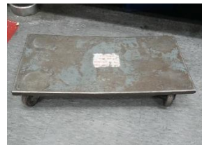
Gambar 2 Trolley Untuk Mengangkat Material Spool Wire
