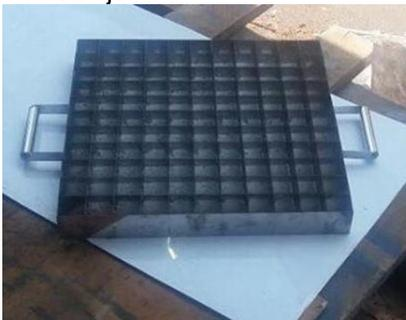
**Gambar 4** Alat Pemotong Tahu
