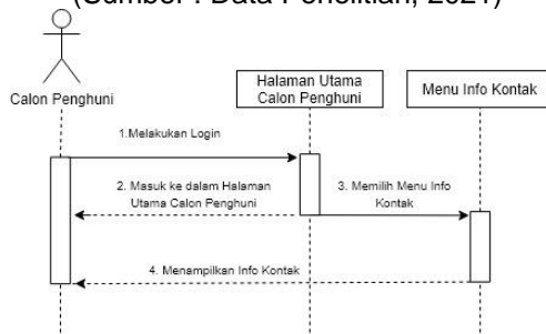
Gambar 23. Info Kontak (Sumber : Data Penelitian, 2021) Class diagram merupakan untuk menggambarkan dan melakukan pengartian pada struktur pada rancangan web penelitian ini, berikut gambar class
