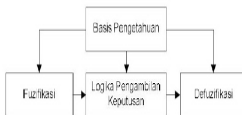
Gambar1 Struktur dasar pengendali fuzzy
