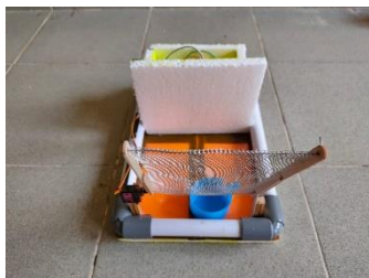
Gambar 11. Motor Servo Sesudah mengangkat sampah (Sumber: Data Penulis,2022)
