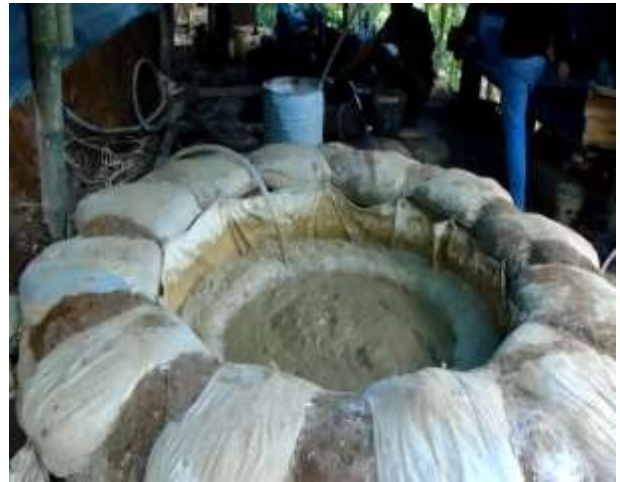
Gambar 5 : Pengolahan Biji Emas Dengan Menggunakan Sianida
