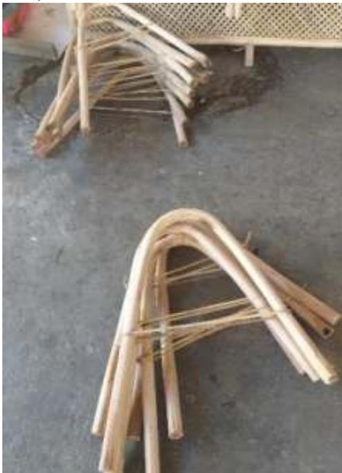
**Gambar 7.** Teknik Pembungkukan / Pembungkukan Rotan:
