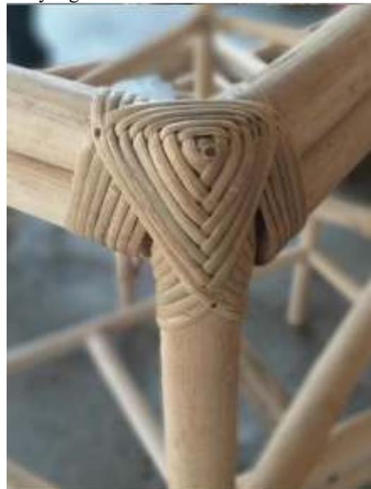
**Angka 8.** Teknik mengikat ujung sambungan rotan
