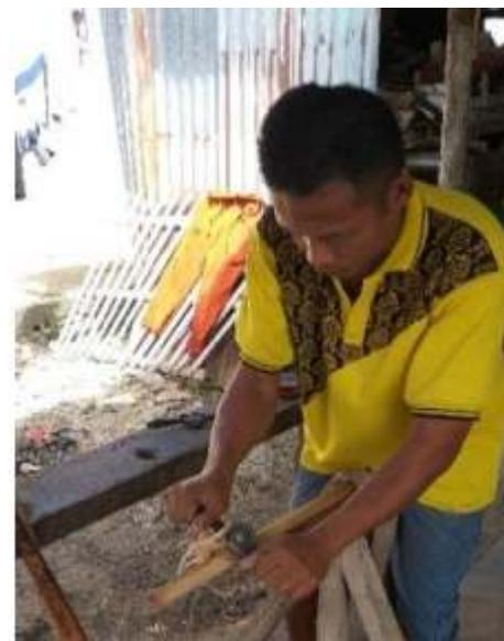
**Gambar 6.**Teknik Capping Kulit Rotan menggunakan silet
