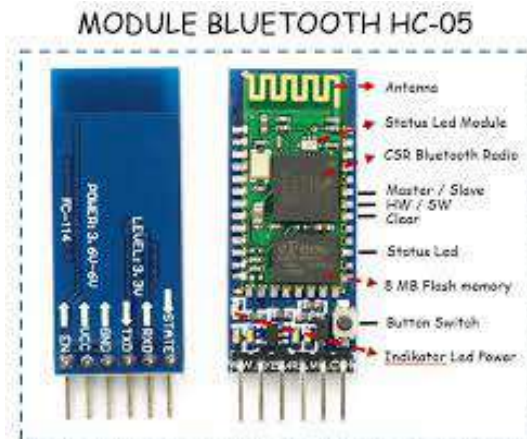
Gambar 2. Module Bluetooth HC-05 (Sumber: (Wirawan, 2018))
