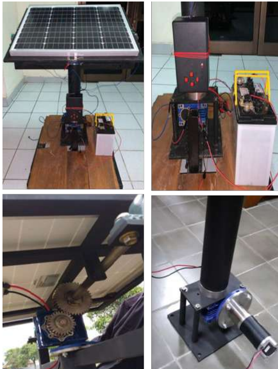
Gambar 7. Sistem mekanik pelacak cahaya
