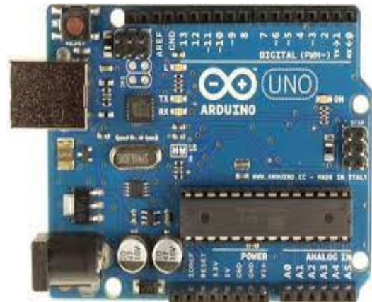
Gambar 1. Tampilan Arduino Uno (Sumber: (Setiawan, 2017))
