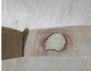
Gambar 3. Dokumentasi Defect Gelembung Sumber : Data PT. SXX
