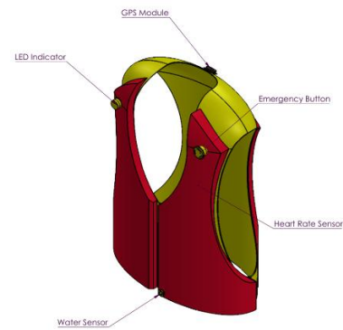
Gambar 5. Posisi Sensor Pada Life jacket
